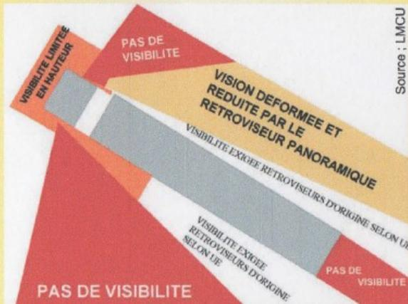
Chaque camion présente plusieurs angles morts : à l'avant, à l'arrière et sur les flancs. Les angles morts existent aussi en hauteur : à l'aplomb de sa cabine, le chauffeur a une visibilité limitée.
